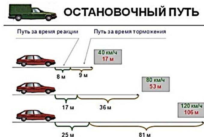
Рисунок 16. Составляющие остановочного пути
